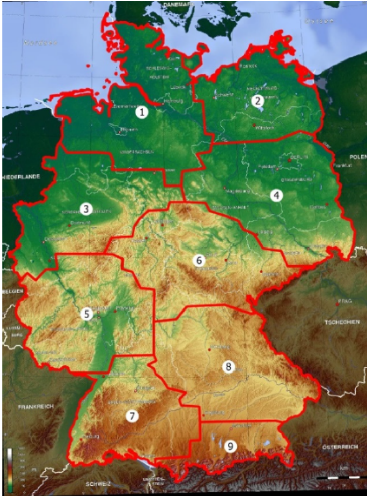
Abbildung 24: Regionale Gliederung des Übertragungsnetzes zur Ermittlung witterungsabhängiger Strombelastbarkeiten von Freileitungen; (Quelle: Übertragungsnetzbetreiber 61 )
