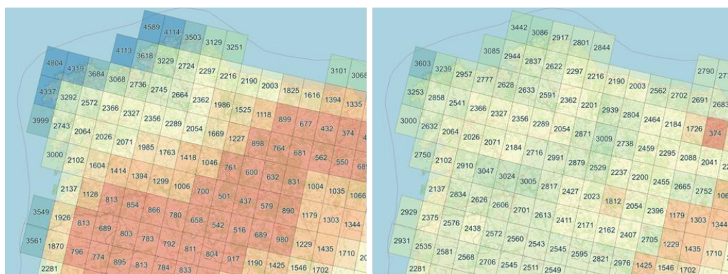
Abbildung 5-8: Auswirkung des Korrekturmodells auf die Volllaststunden (Ausschnitt Nordwest-Spanien, links vor Korrektur, rechts nach Korrektur)
