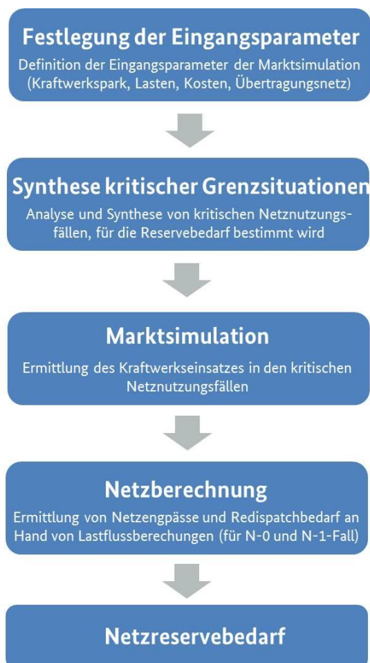
Abbildung 5: Übersicht über das Verfahren zur Ermittlung des Bedarfs an Netzreserve. Dargestellt sind schematisch die einzelnen Schritte zur Ermittlung des Bedarfs an Netzreserve (vgl. Abschnitte 1.3-1.6)
