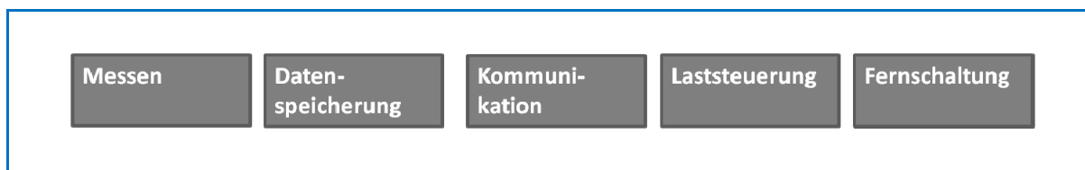
Abbildung 2: Funktionsgruppen eines Smart-Metering-Zählers (Quelle: EnCT)
