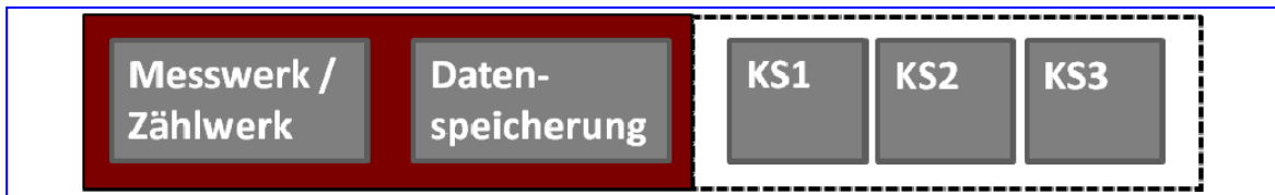
Abbildung 12: Gerätekonzept modularer Zähler (Quelle: EnCT)
