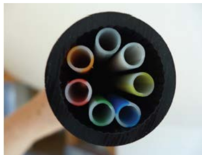
Abbildung 3-11: Kabelschutzrohr DN50 mit 7 Rohr-in-Rohr Mikrorohren 10 x 1mm
